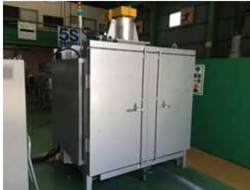
熱風循環構造(天井ファン搭載)
