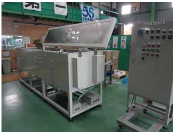
熱風循環構造 (床面ファン搭載)
