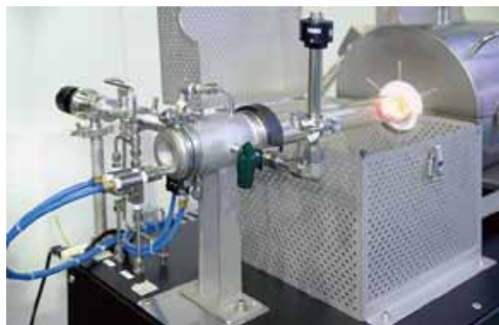
水冷構造よりOリング高寿命設計で気密性が持続します
